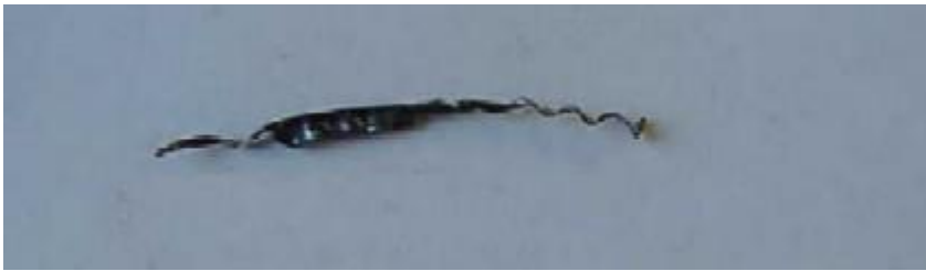
钻屑短而粗，正确
